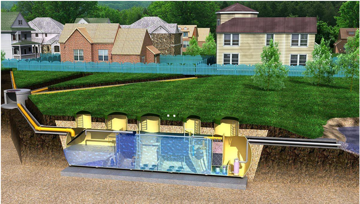
Рисунок 9. Схема биологической очистной станции.
