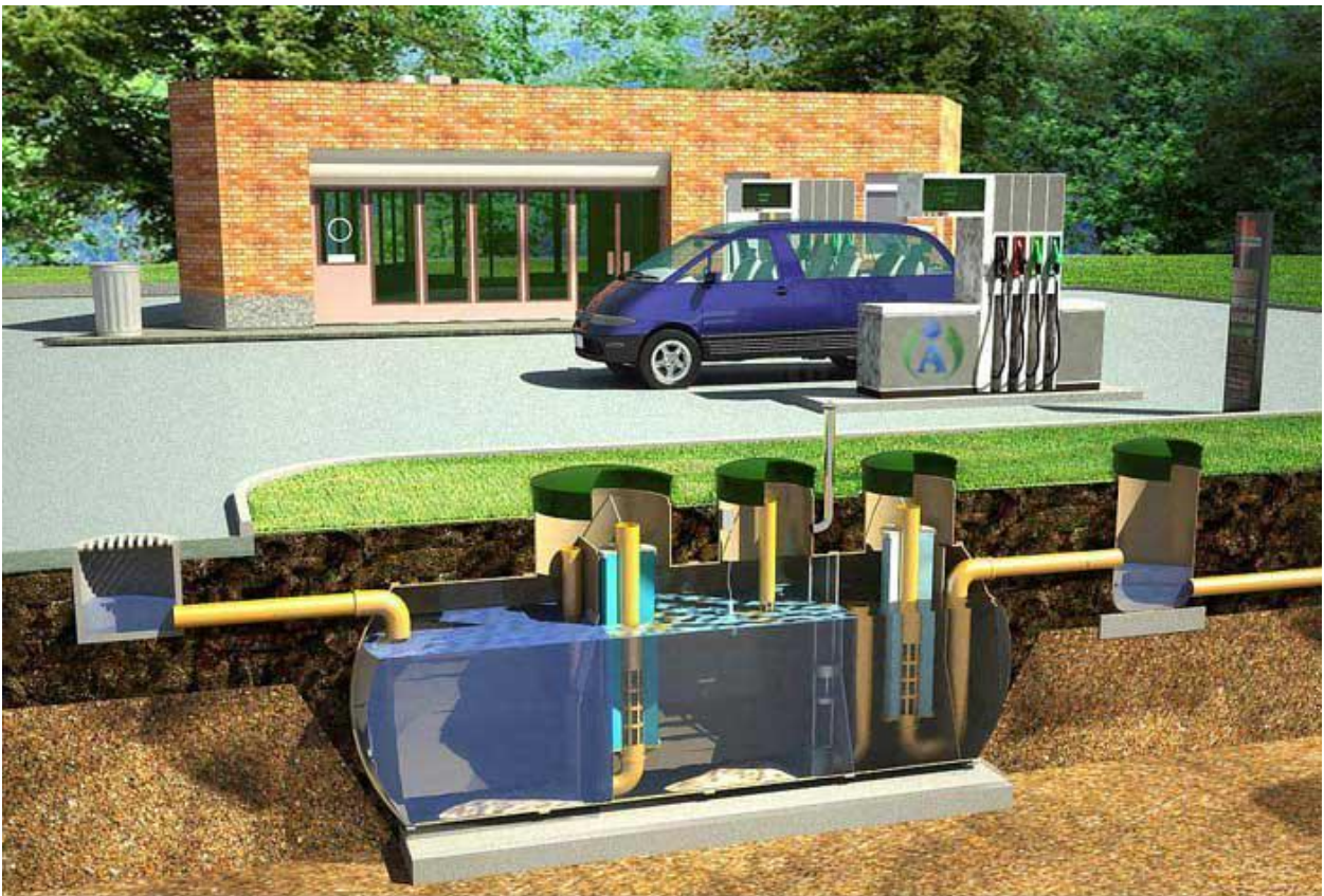
Рисунок 10. Схема очистного сооружения ливневой канализации.
