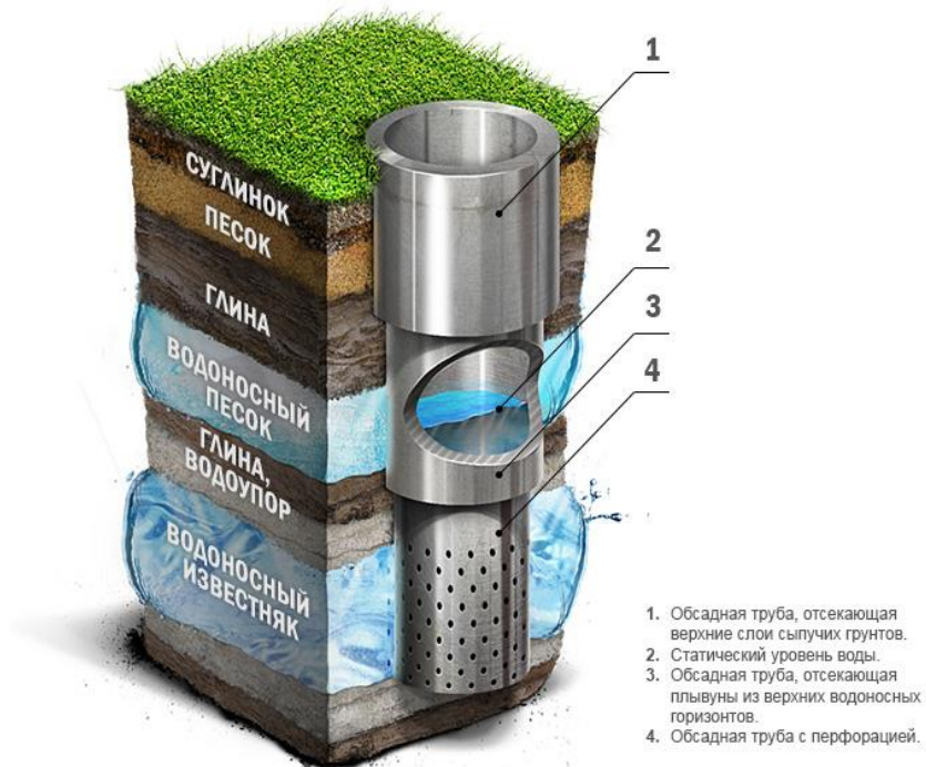
Рисунок 6. Схема артезианской скважины.
